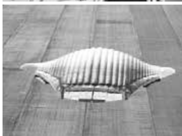
Der STINGRAY ist ein Nurflügler, dessen leichte Bauweise mit luftgefüllten Textilflügeln auch andernorts zum Einsatz kommt.
