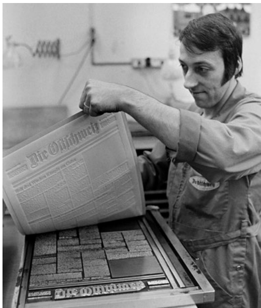
Als Zeitungsmachen in erster Linie noch Handwerk war: Ab einem sogenannten Schiff mit der in Blei gesetzten Titelseite der «Ostschweiz» wird eine Matrize gezogen, die dann als Vorlage zur Herstellung der Druckplatte dient. (Bild: Stadtarchiv St. Gallen)
